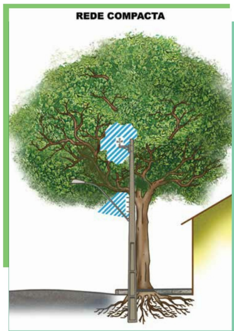
Figura 38 – Área de poda com passagem de rede compacta
