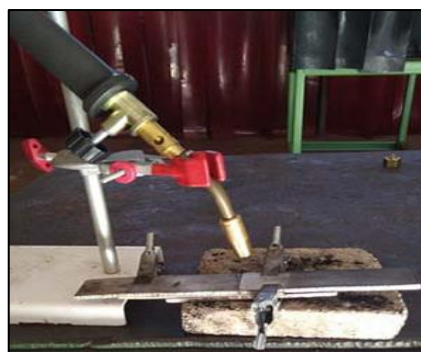
Figura 2. Maçarico direcionado às amostras a serem soldadas.
