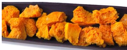
Figura 1. Resina fenólica curada e triturada para ser dirigida ao forno tubular.
