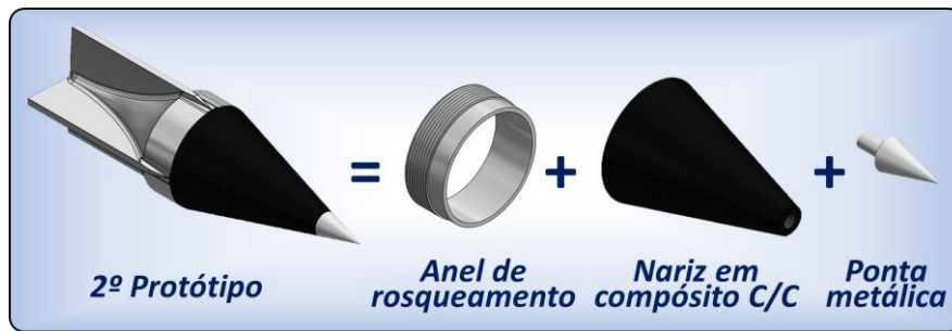
Figura 5. Projeto do segundo protótipo de modelo hipersônico com partes em compósito C/C.
