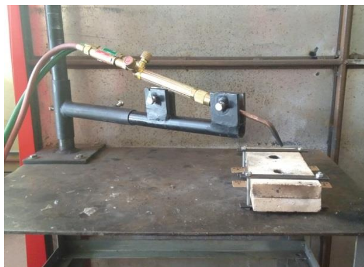
Figura 3. Sistema final desenvolvido para a soldagem por Oxi-acetileno de compósito PEI.
