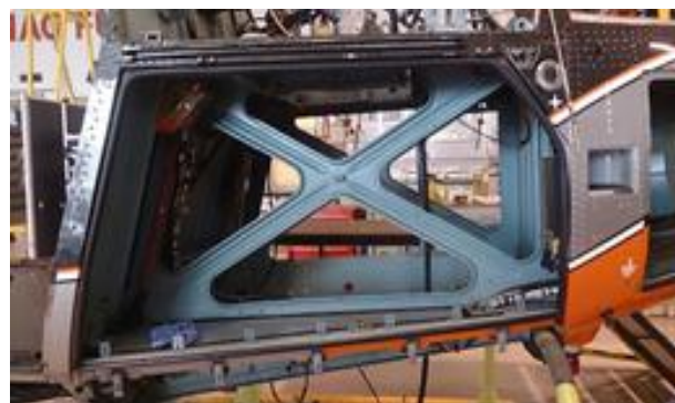
Figura 3: Estrutura compartimento do tanque.
