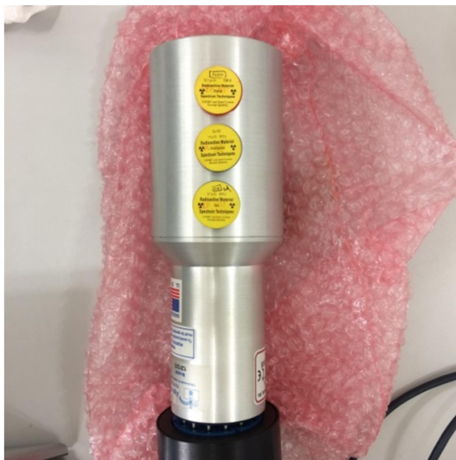
Figura 03: Foto do “Gamma ray spectrometer” em contato com os elementos radioativos Cs-137, Sr-90 e Po-210.
