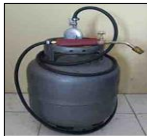
Figura 1. Equipamento de soldagem por GLP utilizado no trabalho.
