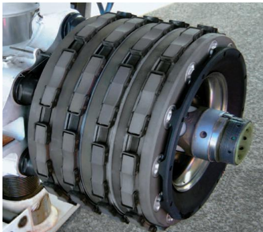
Figura 1. Sistema de frenagem utilizado nas aeronaves da família 737 da Boeing [1].
