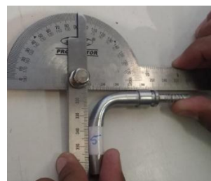
Figura 1. Transferidor de ângulo.
