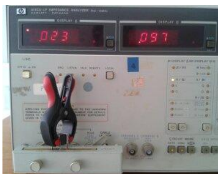
Figura 4. Esquema final para a medição da impedância.
