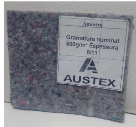
Figura 1. Manta de revestimento termo acústico utilizado em automóveis.
