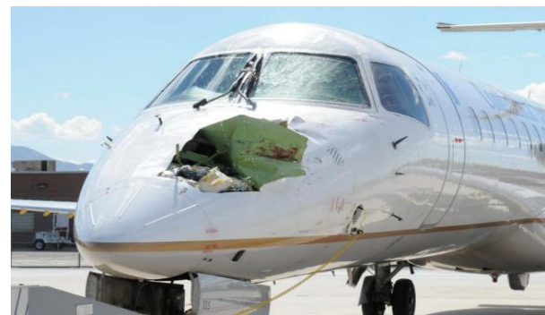
Figura 3. Embraer 145 após colisão com ave; Foto por M. Smith, USDA[7].
