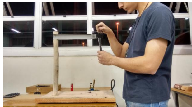
Figura 3. Fixação do corpo de prova para ensaio UL-94 VB[6].
