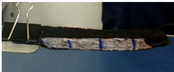
Figura 10. CDP com cola de contato e revestimento duplo (RD) com a chama extinguida.
