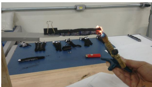
Figura6: Realizando o ensaio UL-94 HB[6]
