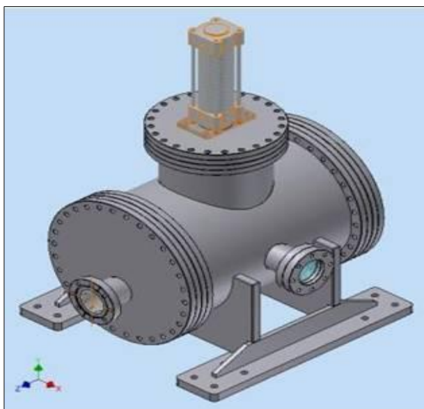
Figura 12. Câmara de Ø 12"X 40 cm, com apenas um atuador pneumático.
