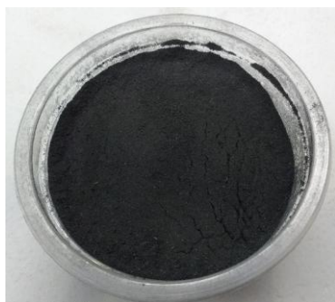
Figura 3. Pó do compósito de carbono após o processamento mecânico.
