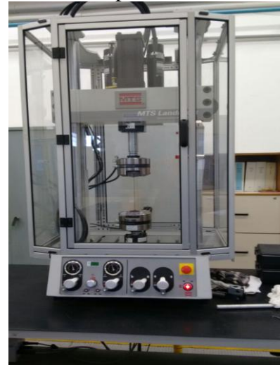
Figura 10. Máquina de Ensaio de propriedades mecânicas
