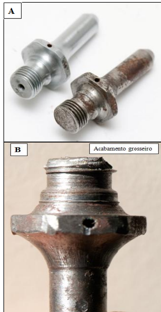
Figura 4 -(A) vista geral dos pinos novo e usado. (B) detalhe do acabamento grosseiro entre o corpo roscado e a base.
