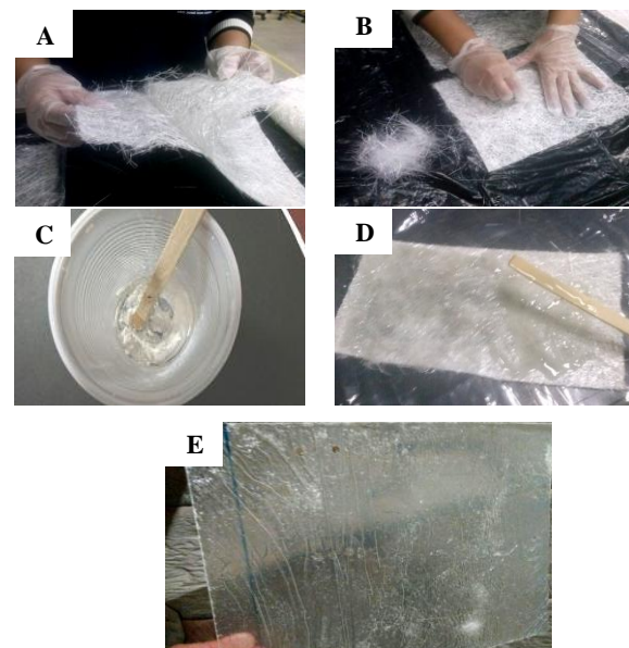
Figura 08. Sequência de preparação das placas de compósito para ensaios mecânicos comparativos: A) e B) retirada de material virgem da manta de reforço C) Mistura de resina poliéster mais reciclado pulverizado, D) impregnação, E) placa de compósito PRFV pós cura.
