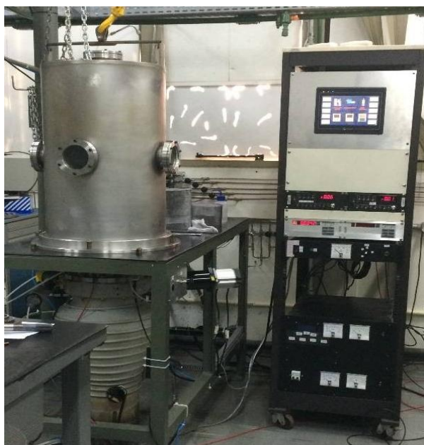
Figura 2. Reator CVD assistido por plasma DC pulsado
