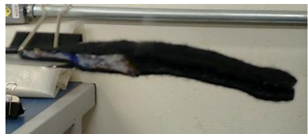
Figura 9. CDP com cola Diesel e revestimento duplo (RD) com a chama extinguida.
